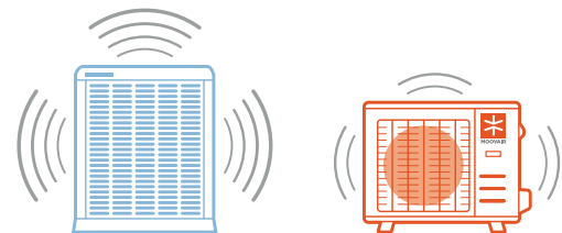
Système central traditionnel: 73 dB(A) Système Central-Moov: 58 dB(A)
